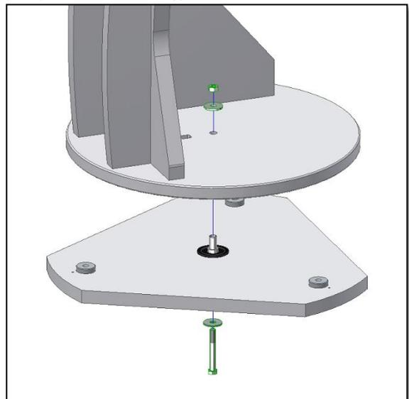
**Figura 9.** Posizionate questo gruppo premontato sopra la base triangolare (componente 15). Usate la vite, le rondelle e il dado per stringere nuovamente questi componenti. Usate le chiavi fisse fornite.
