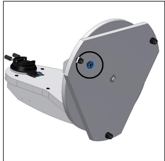
**Figura 13.** Avvitare completamente la base dei piedini. Saranno usate successivamente per livellare la base.
