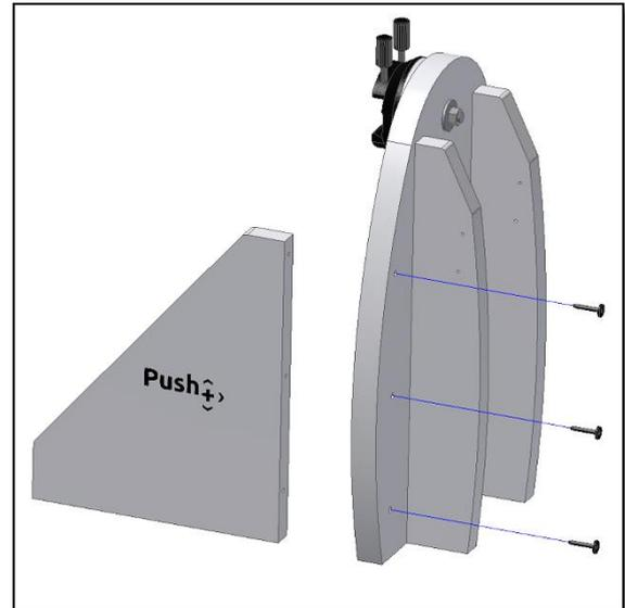
**Figura 5.** Anche il pannello frontale (componente 13) viene fissato ai componenti precedentemente montati.
