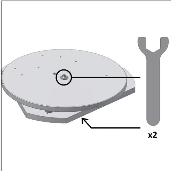
**Figura 6.** Togliete il disco (componente 14) usando le due chiavi fisse fornite.
