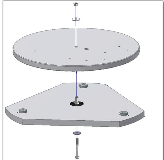
**Figura 7.** Togliete la vite centrale, le rondelle e il dado e metteteli da parte per il successivo rimontaggio.
